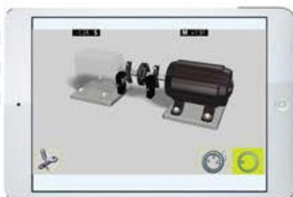
Pivoter les capteurs à la position 9:00 et appuyer sur l'icône mesure.
